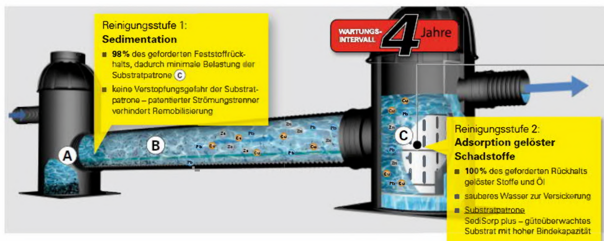
Abbildung 5-12: Schematische Darstellung des SediSubstrator® (Fränkische, 2019)
